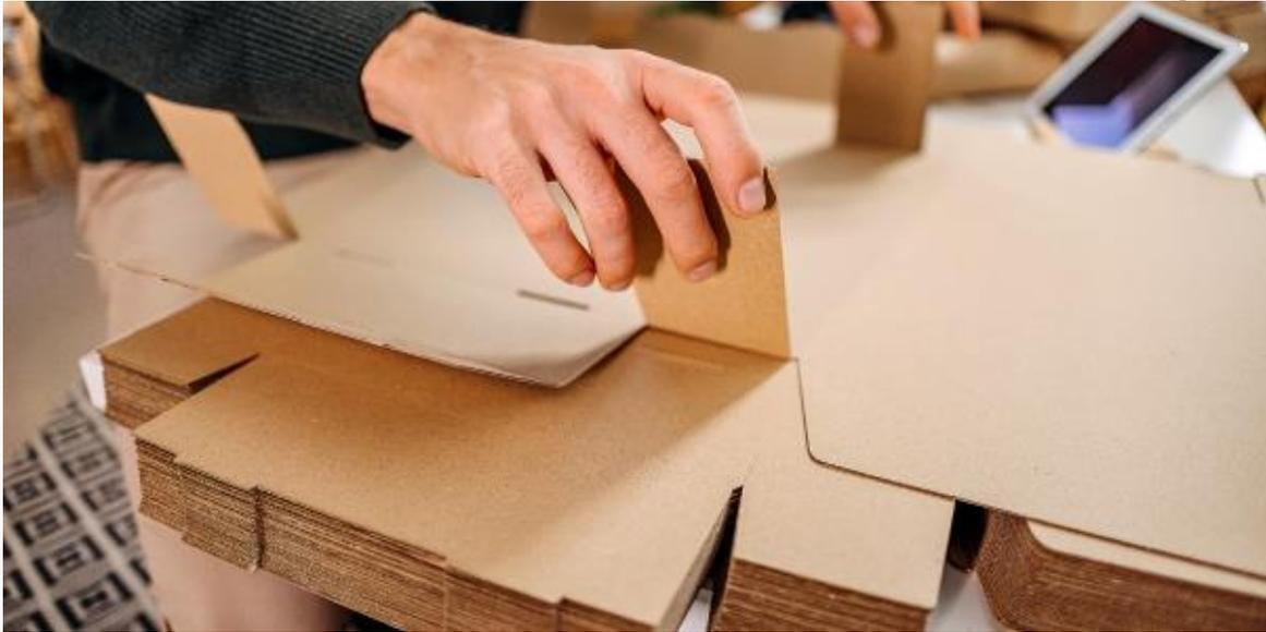
**EL TROQUELADO ES UN PROCESO QUE CORTA MATERIALES COMO PAPEL Y CARTÓN MEDIANTE UNA HERRAMIENTA DE BORDES AFILADOS DISEÑADA CON LA FORMA DE LA PIEZA TERMINADA**
